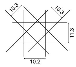
0°: Gitterabstand: 10.2 mm -45°: Gitterabstand: 10.3 mm 90°: Gitterabstand: 11.3 mm +45°: Gitterabstand: 10.3 mm
