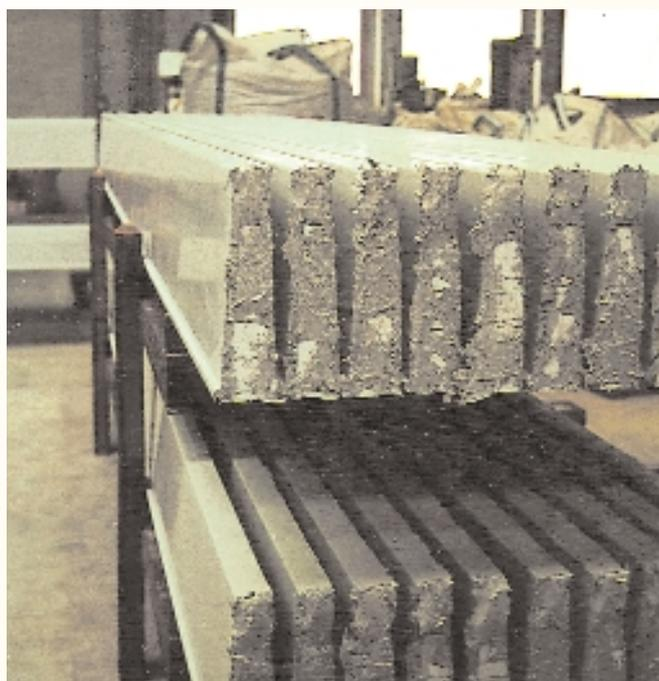
(Bild 14) Fensterbänke aus Glasfaserbeton nach dem Extrusionsverfahren.
