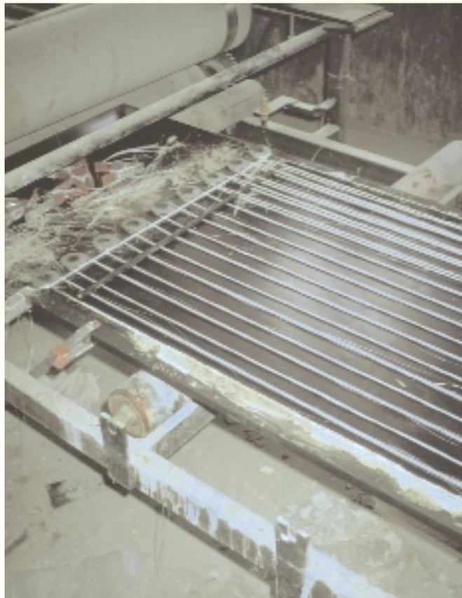
(Bild 7) Glasfaserrovinge als Bewehrungstränge innerhalb einer Platte.
