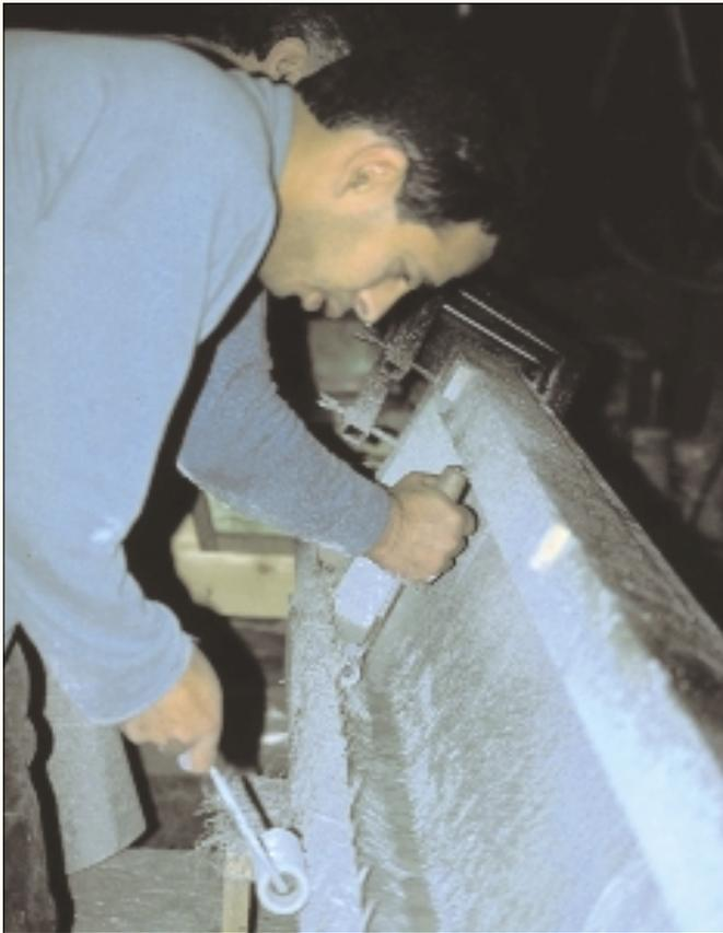
(Bild 3) Verdichten der einzelnen Lagen der Matrix und Glasfasern.
