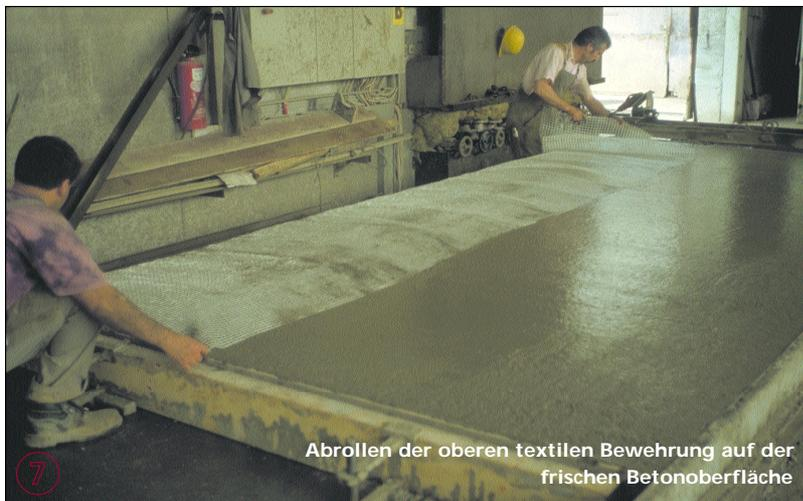
Abrollen der oberen textilen Bewehrung auf der frischen Betonoberfläche
