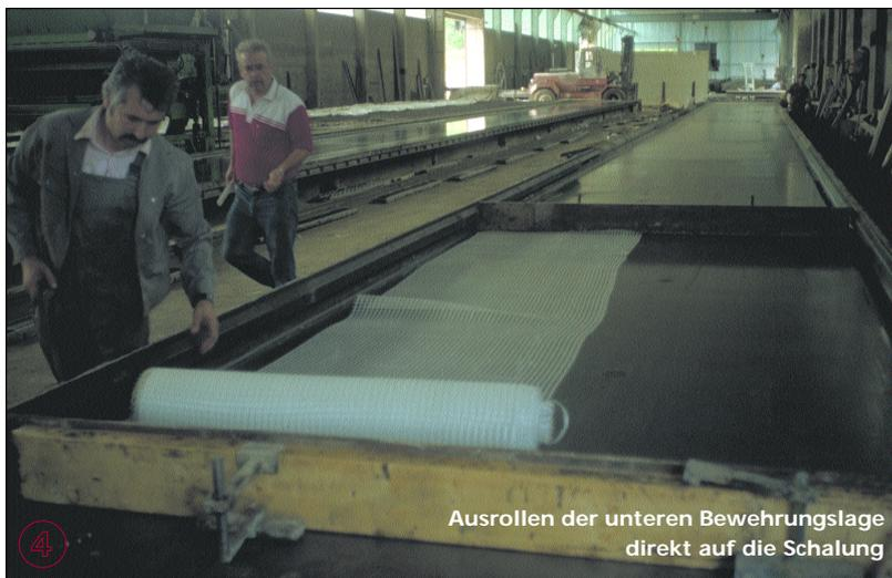
Ausrollen der unteren Bewehrungslage direkt auf die Schalung
